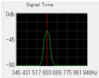
続いて、リグの VFO を操作し、デコードしたいモールス信号が、サイドトーン同様、赤い『縦線』上にピークが来るようにしますと、画面左側の“CW Signal Level”にモールス信号の ON/OFF に従った波形が観察できます。
