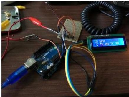
ダウンロードできるスケッチ (Arduino では、プログラムのことをスケッチと呼びます) では、デフォルトでは抽出する周波数が 558Hz (`"target_freq=558.0"`) になっていますので、自身の無線機のサイドトーン・ピッチを変更するか、古いリグならば概ね 700Hz 辺りですの
