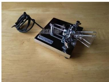
パドル(マニピレータともいう)は、エレクトリック・キーヤー(電子回路を用いて自動キーイングを行う装置)と組み合わせて使用されるもので、短点、長点それぞれに対応する 2 枚のレバーがあり、親指と人差指で操作します。レバーを押している間は短点あるいは長点が連続送信されます。通常は別々にレバー
