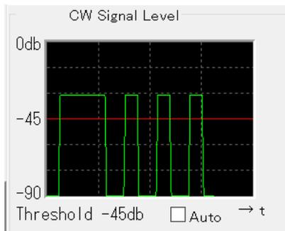
”CW Signal Level” にある赤い『横線』を、凡そのノイズより上、モールス信号波形のピークより下に設定することで、デコードが正しくおこなわれるようになります。
