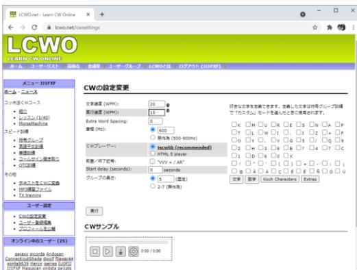
『文字速度』を変更しないのは、実際の CW 交信では 20WPM くらいが多いため、この速度を落としてしまうと後々の実交信で困ります。ここは、どんなに低速にしても 15WPM 以上をキープしてみてください。それでも回答のキーボード入力が間に合わない場合は、『Extra Word Spacing』で調整します。
