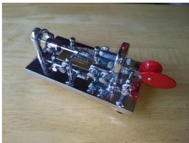
バグキーは、写真からわかるように 1 枚のレバーがあり、これを親指と人差指で操作します。モールス符号の長点(ツート)はその都度接点に触れるように操作しますが、短点(トン)は振り子の反動の原理を用いて自動的に連続送信できるようになっています。筆者の個人的感想ですが、この電鍵では操作者の個性的な符号が送信されると思います。
