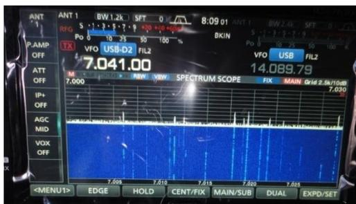
スコープの一例を示します。7000~7030kHz を表示して、ダイヤルは 7041.00kHz USB モードですが CW の信号がスコープの範囲内にくっつき見えます。このように一目見ただけでバンドの込み具合、空き周波数がわかります。さらには信号の混み具合からコンディションの良し悪しを推定できるでしょう。
