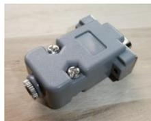
筒状のステレオ・ミニジャックにはんだ付けすると、シェル（ハウジング）にぴたりと収まります。ミニ・ジャックを付けなくても、直接ケーブルを出して、電鍵につなげても OK です。// ATSU, JE I TRV
