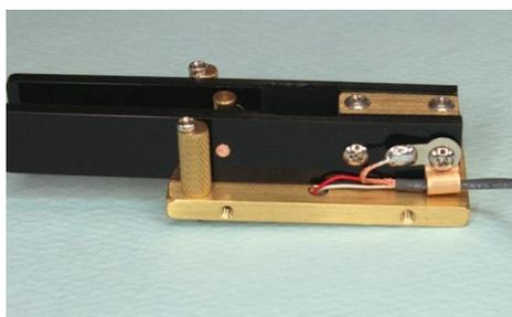
④パドル部は、コードをコードクランプで固定し赤白線を図のように穴に通します
