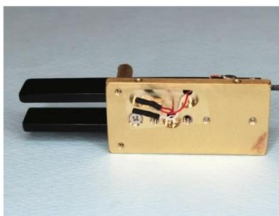
⑤すでに取り付けてある赤線とコードの赤線を半田つけしヒシチューブで処理します
