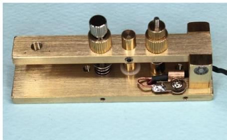
①縦振り部、ケースを外しコードを通してアース線をアース用ラグに半田付けします
